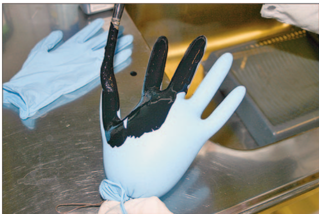
Foto 4. Om handsken är tät kan den med fördel blåsas upp med tryckluft och enkelt penslas med Wet Powder
