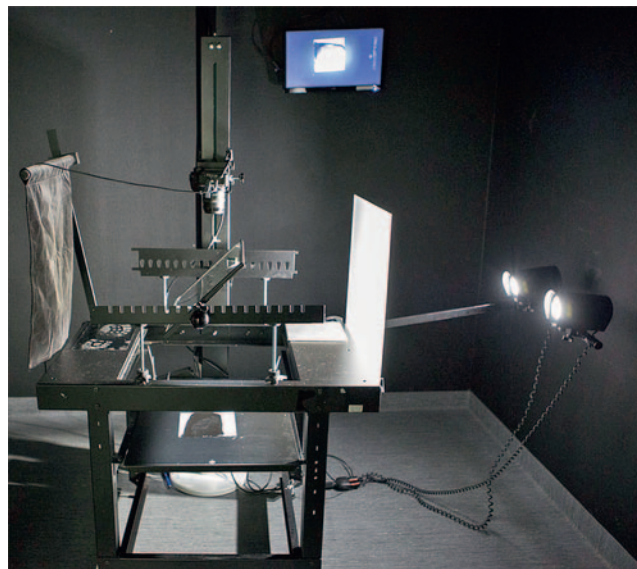
Foto 16. Fotobordet visas med monterat spegelsystem. Objektet som skall fotograferas ligger på plattan strax under fotobords-skivan. Mellan objektet och kameran finns en semitransparent spegel, vars infästningsvinkel är justerbar (normalt ca 45 grader). Till höger på fotot har en matt akrylplastskena monterats. Den belyses med två av fotobordets lampor, båda med mattfilter för att ge en jämn ljusfördelning på akrylskivan. Det ljus som skivan ger motsvarar i hög grad «himmelsljuset» som beskrivits ovan. Cirka 50 % av det jämna ljuset från akrylskivan kommer att reflekteras i spegeln mot objektet. Resten av ljuset passerar den halvtransparenta spegeln och träffar den extremt svarta sammetstyget, som syns hängande på en av ljusarmarna till vänster på fotot. Med kameran fotograferas nu objektet genom spegeln. Utan användning av det svarta sammetstyget skulle två olika bilder framträda i kameran, spårbilden och andra störande objekt från fotoateljén
