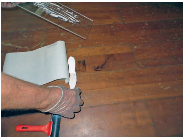
Foto 10. Ett spår har avsatts med blod på ett golv av plastmaterial. Spåret har framkallats med svart Wet Powder med teknik som beskrivits under foto 7. En av kortsidorna av silikonpapperet fästes mot golvet nära spåret med en bred tejpremsa. Tillblandad MIKROSIL läggs på spårets skyndsamt. En gummivals, som pressas hårt mot papperet, rullas framåt, varvid ett tunt lager MIKROSIL kommer att flyta ut och täcka spåret
