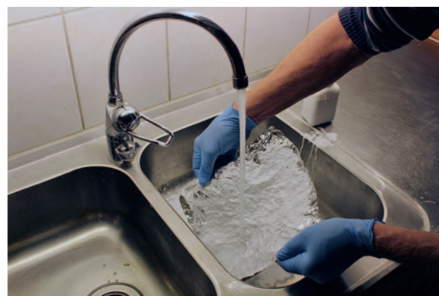
Foto 23. Avsköljning (rensning) under rinnande vatten
